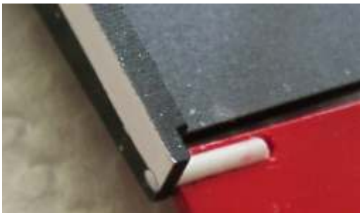
19. Rundstab durch das Loch von Teil 4 beidseitig mit Teil 15 verkleben.
