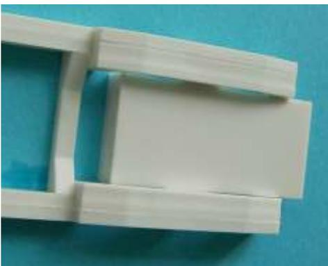
6. Hinteren Block zwischen die Teile 1 LEGEN, damit diese parallel liegen und das erste Teil 9 einkleben.
