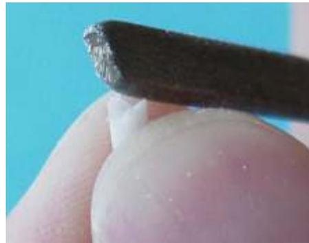
15. Rundrohr mit der Feile einkerben.
