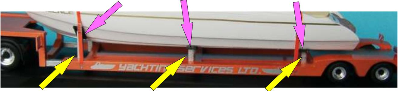
13. Die Teile 16 dienen der Bootsaufnahme und können nach Belieben selbst eingekürzt und verklebt werden.
