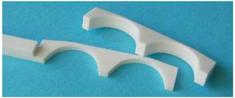
2. Teile 3 an Teile 1 kleben. ACHTUNG, nur in einer Richtung passgenau!
