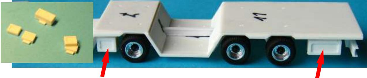
Die Staukästen sind alle 2teilig und müssen zusammengeklebt werden. Anschließend unter das Fahrgestell kleben.
