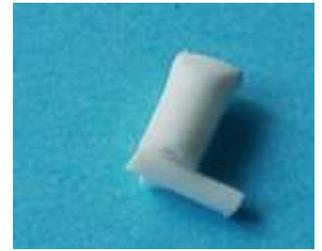
Der Königszapfen: 2,5mm Rundstab kerben, Stück 1mm Rundstab kleben und dann das ganze in das Loch der Grundplatte kleben.
