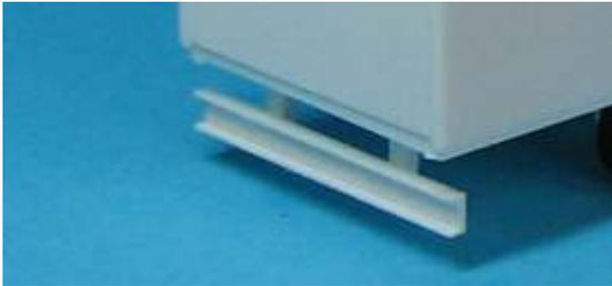
Beide Traversen werden erst mit dem U-Profil und dann mit dem Fahrgestell verklebt.
