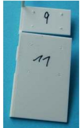
Die Bohrungen dienen der genauen Fixierung der Radaufnahme.
