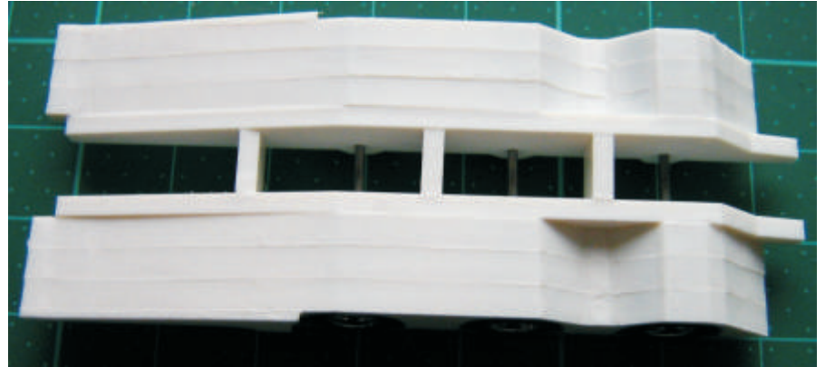
Die Teile 1 an Teile 2 kleben. Teil 1 muss unten 0,5mm überstehen.
