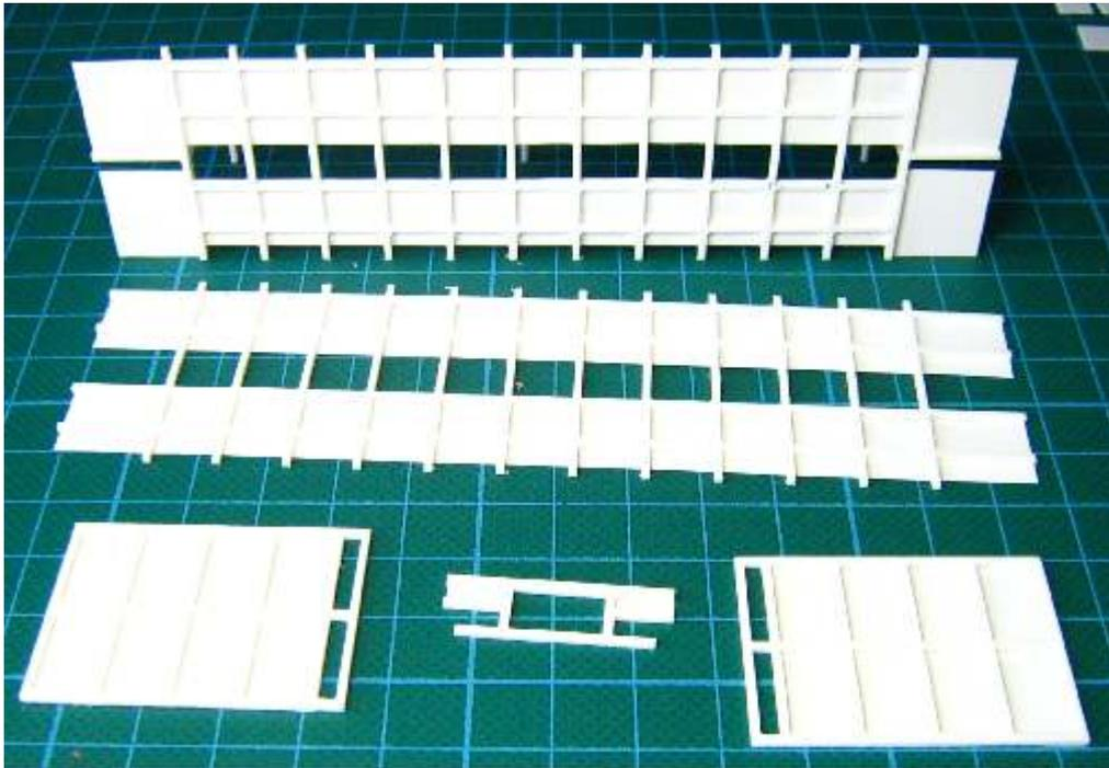
Das beiglegte 0,1mm Material wird mit der Schere zugeschnitten und als Innenwand an die Teile 2,3,7 und 6 geklebt.
