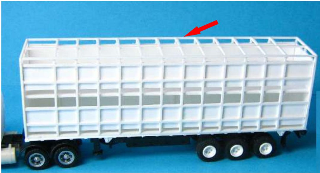
Teil 4 wird als Deckgitter oben in den Aufbau geklebt. Teil 6 bildet hinten die Heckblende und kann einfach untergeklebt werden.
