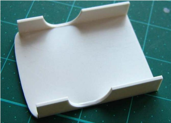
Die Bodenplatte ZWISCHEN die Seitenteile kleben.
