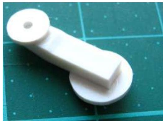
Beide Sattelscheiben mit Sattelarm verkleben.
