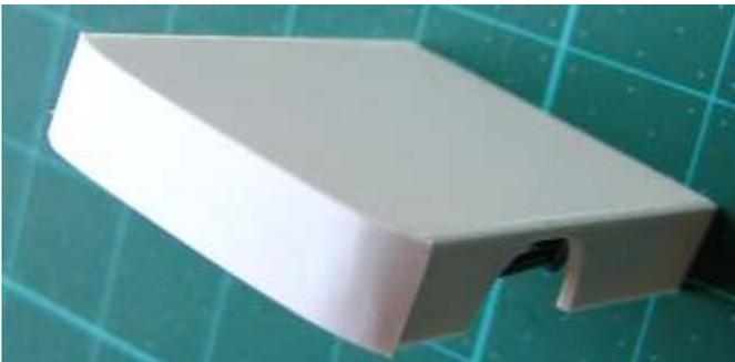
Das dünne Material zuschneiden und um das Heck als Verkleidung kleben. An den Kanten sollte gepachtelt werden.
