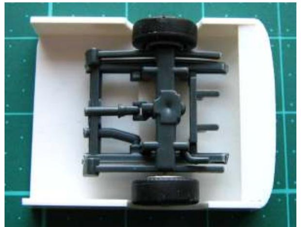
Je nach verwendetem Chassis ist dieses zu kürzen. ein mitgeliefertes 1,5mm Material ist zwischen Chassis und Bodenplatte zu kleben
