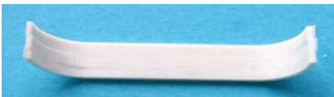
2x 2mm und 1x 1,5mm dicke Teile ergeben einen Radkasten.
