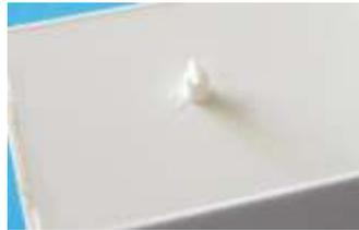
Der Königszapfen: 2,5mm Rundstab kerben, Stück 1mm Rundstab kleben und dann das ganze in das Loch der Grundplatte kleben.
