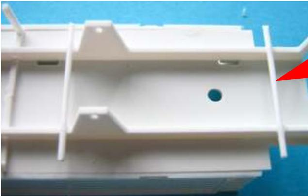
2x ca. 28mm Rundstab zuschneiden und in die Kerben kleben
