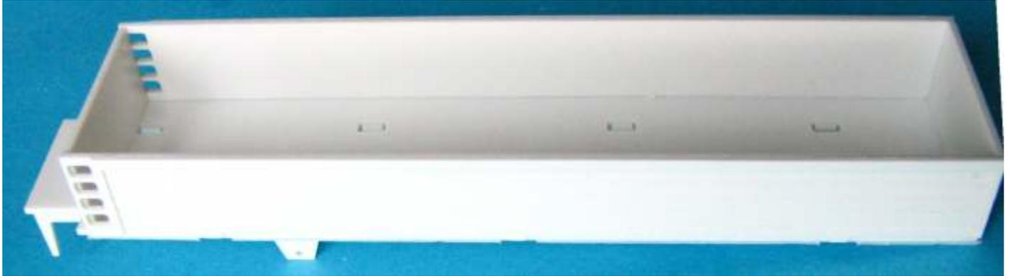
Zuerst wird die Frontplatte unten bündig an die Bodenplatte geklebt. Auf den so entstandenen Winkel können nun die Seitenteile geklebt werden. Die Heckplatte (1mm kürzer als die Frontplatte) wird zuletzt hinten eingesetzt.
