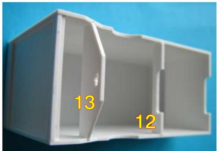
Teil 13 wird in die Nuten geklebt. Teil 12 ist ohne genaue Position und dient als Chassisauflage
