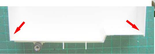
Achtung beim Einkleben des Chassis! Die Bodenplatte muss hinten bündig mit der Seitenwand abschließen, aber vorn bündig mit der Chassisunterkante. Also vorn tiefer drin sitzen.
