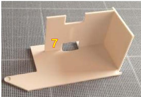
Die Bodenplatte 7 wird in die Nut der Seitenwand 1 geklebt.
