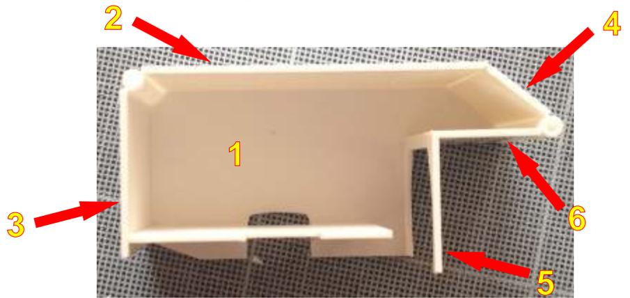
Die restlichen Teile werden bündig auf die Seitenplatte geklebt. Für die Ecken wird das beiliegende Rundrohr zugeschnitten und in den Ecken verklebt. Alles wird mit der zweiten Seitenwand abgeschlossen. Alle offenen Kanten werden verspachtelt und verschliffen.
