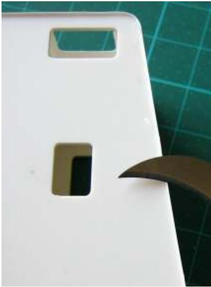
Der überstehende Rand des Daches wird nun mittels Skalpell entfernt.
