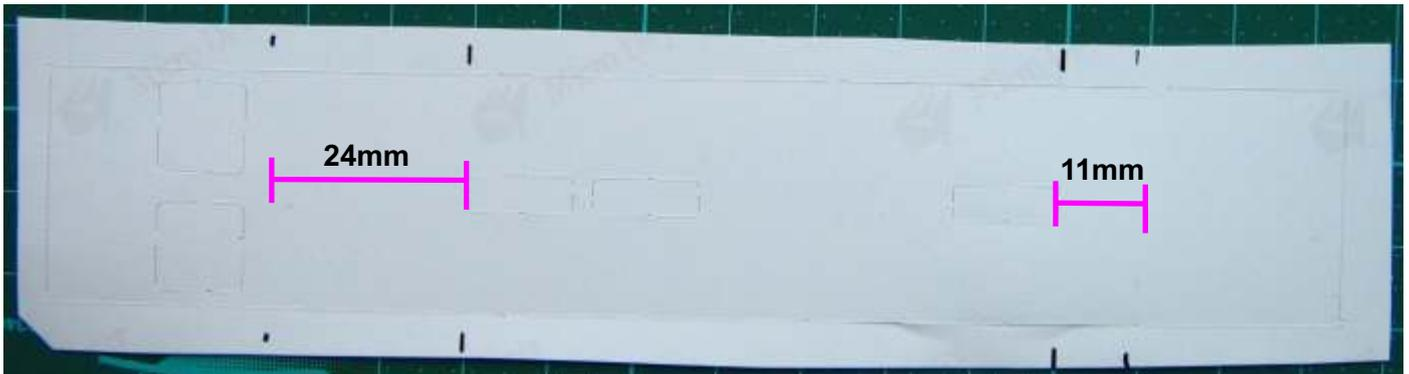
Auf der mitgelieferten vorgeschnittenen Dachplatte ausserhalb folgende Bereiche markieren: Hinten eine Linie ca. 24mm von Ende des letzten Dachfensters und vorn ca. 11mm vom Ende des vorderen Dachfensters. In diesen Bereichen muß das Material vor dem Kleben vorgebogen werden.
