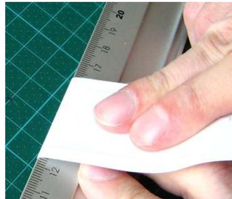
Es empfiehlt sich ein Alulineal mit RUNDER Kante. Auf Markierung aufsetzen, Lineal andrücken und das Material langsam ca. 4mm herausziehen. Es entsteht eine Biegung. Mit der anderen Markierung wiederholen und anschließend Fenster und Rand mit dem Skalpell abtrennen.
