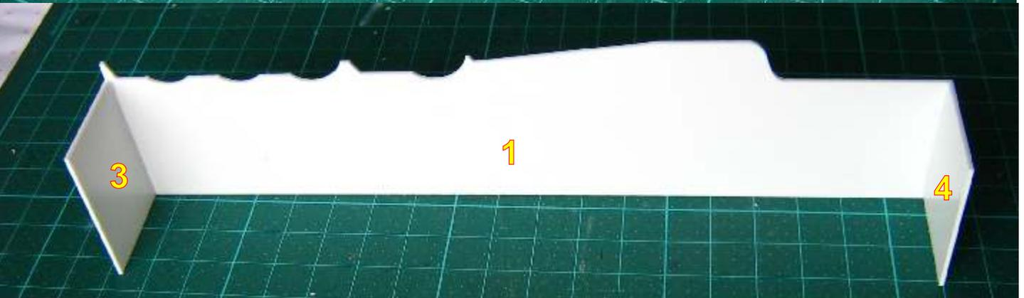
Vorder- und Rückseite werden auf die Seitenwand 1 geklebt.
