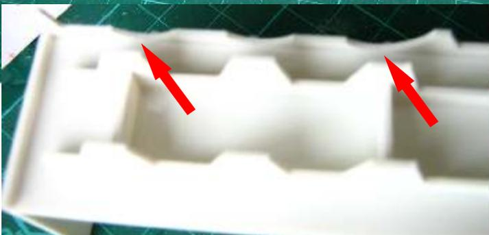
Beim Einkleben des Chassis muss die Grundplatte bündig mit dem Radkasten abschließen, vorne aber ca. 2mm tiefer sitzen.
