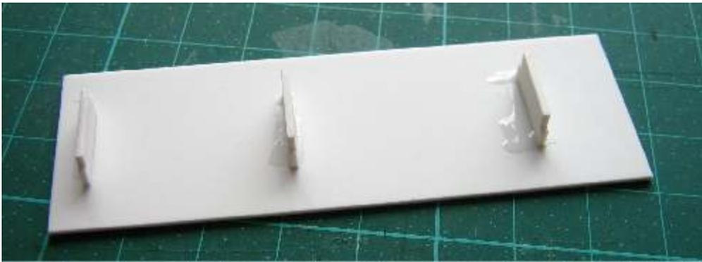
Die Teile 8 werden in Teil 13 gesteckt und verklebt. Danach werden die Teile 7 aufgesteckt und verklebt.
