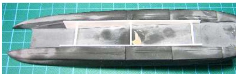
Die Teile 14 sind die Zwischenstreben der Teile 8. Diese passt man am besten direkt am Boot an.
