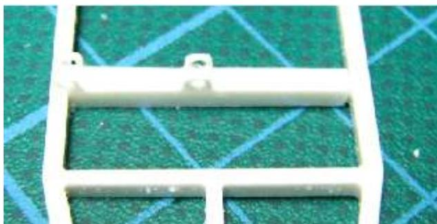
An die Zwischenstreben von Teil 6 werden die Teile 18 geklebt.
