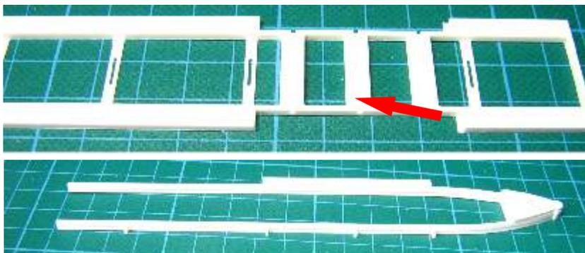
Teil1 wird unter Teil 2 geklebt. Die Nuten für die Achsen müssen dabei weiterhin oben sichtbar sein.
