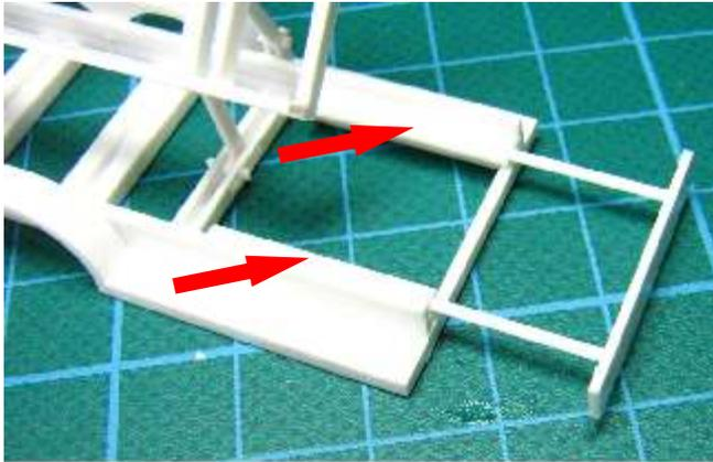
Nun wird das Rundrohr zugeschnitten und eingeklebt. Entsprechende Rundstäbe werden an Teil 15 geklebt. Beides lässt sich nun ineinanderschieben.
